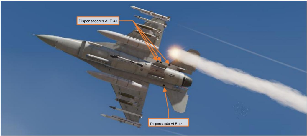
AN/ALE-47 Locais de distribuição de contramedidas aerotransportadas
