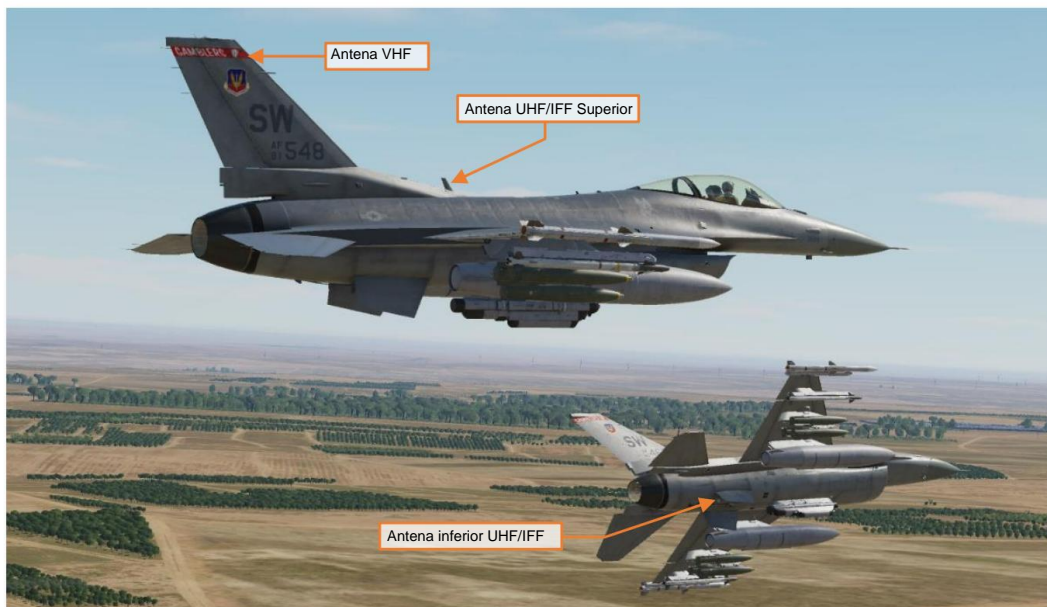
Locais de antena de rádio AN/ARC-164 e AN/ARC-222
